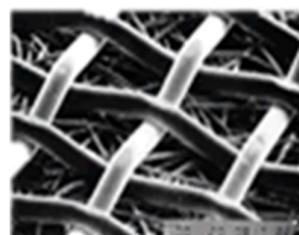
材質は SS316L を主軸に Hastelloy、ニッケルといった耐腐食性の高い素材を使いフィルターを制作する為、医薬・化学業界向けなど過酷な条件下での用途で使われることが多い製品になります。ろ過精度は公称ろ過精度で  $2\mu\text{m}$  (絶対ろ過精度で  $10\mu\text{m}$  程度) のフィルター製品を製造しています。粗目側は数 mm~cm など顧客ニーズに合わせて様々提案可能です。
